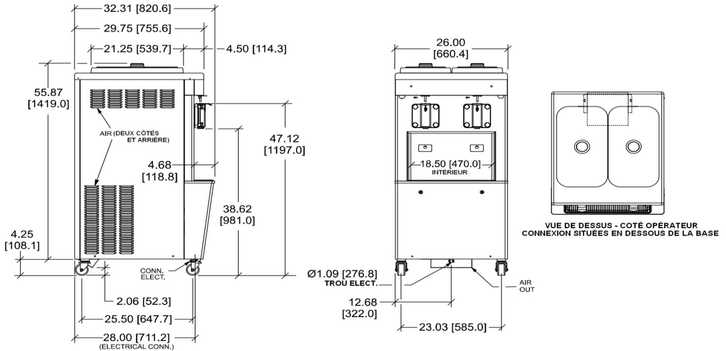
LES CHIFFRES ENTRE CROCHETS EST INDIQUÉ EN MILLIMÈTRES/LES DIMENSIONS DÉCIMALES ET FRACTIONNAIRES SONT ÉGALES À PLUS OU MOINS 1/16 POUCE [1.5 MM]
